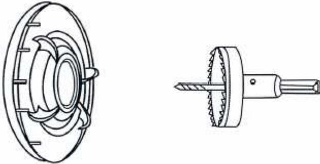
4. Entfernen sie nun die Schutzkappen von den Xenonbrennern und achten sie darauf die Glaskolben nicht zu berühren, da diese durch Fett und Schmutz, was sich unter Betrieb erhitzt beschädigt werden können.
