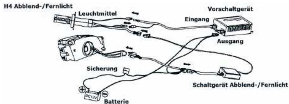
7. Befestigen sie nun die Anschlussleitungen (mit den Flachkabelschuhen) an den originalen Anschlüssen, welche sonst an das Originalleuchtmittel gehen würden. Verschließen sie nun mit der mitgelieferten Gummidichtung den Scheinwerfer wieder mittels des Lochs, welches sie vorher gebohrt haben.
