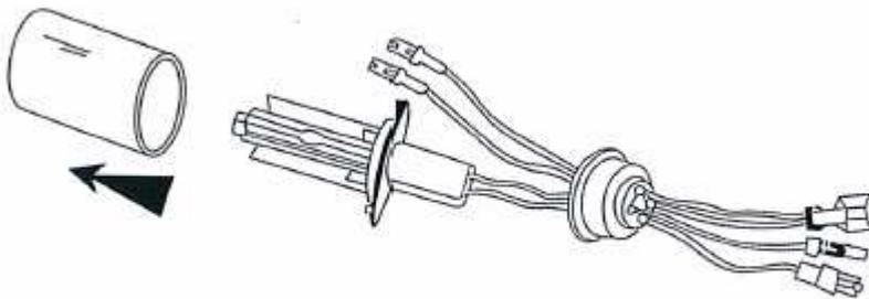
5. Montieren sie nun den Xenonbrenner in der originalen Lampenfassung und befestigen sie diesen mit den originalen Halteklammern.
